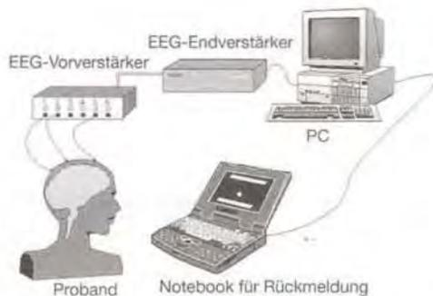
Abb. 4.4. Beispiel für eine EEG-Biofeedback-Anordnung. Über Kopfhautelektroden wird das Elektroenzephalogramm beim Probanden abgeleitet und anschließend verstärkt. Von einem PC werden diejenigen Parameter des Signals berechnet (z. B. die langsamen Hirnpotenziale), die zurückgemeldet werden sollen. Die Rückmeldung erfolgt dann auf einem Notebook-Bildschirm in Form eines bewegten Cursors. (Nach Kübler et al. 2001 a, b)
