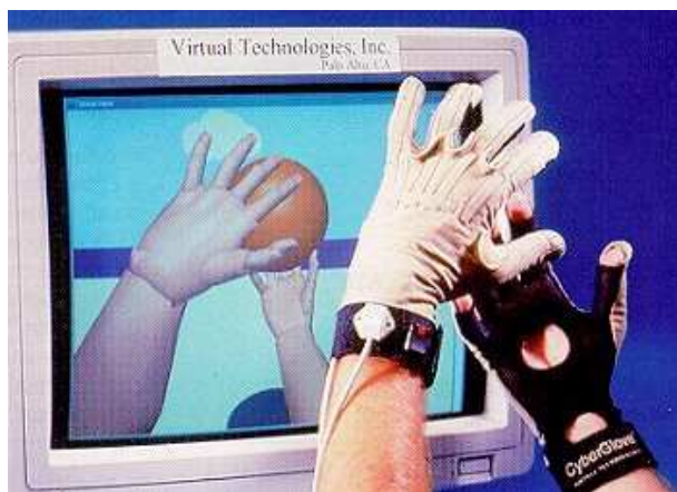
Abbildung 3: CyberGlove zum Abgreifen der Handbewegung
